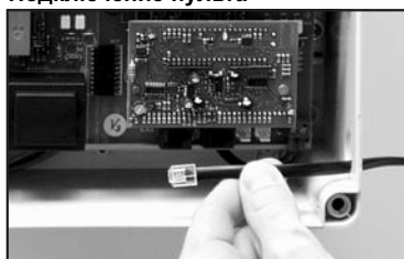
Коммуникационный провод протяните через изолятор
